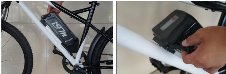
Figura 10 - Batteria d'alimentazione e dispositivo di blocco con la relativa chiave.
